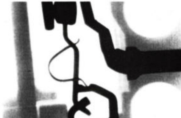
Door een röntgenbeeld van de microschakelaar onstaat, zoals deze opname toont, een gedetailleerd inzicht in de toestand van het inwendige.
