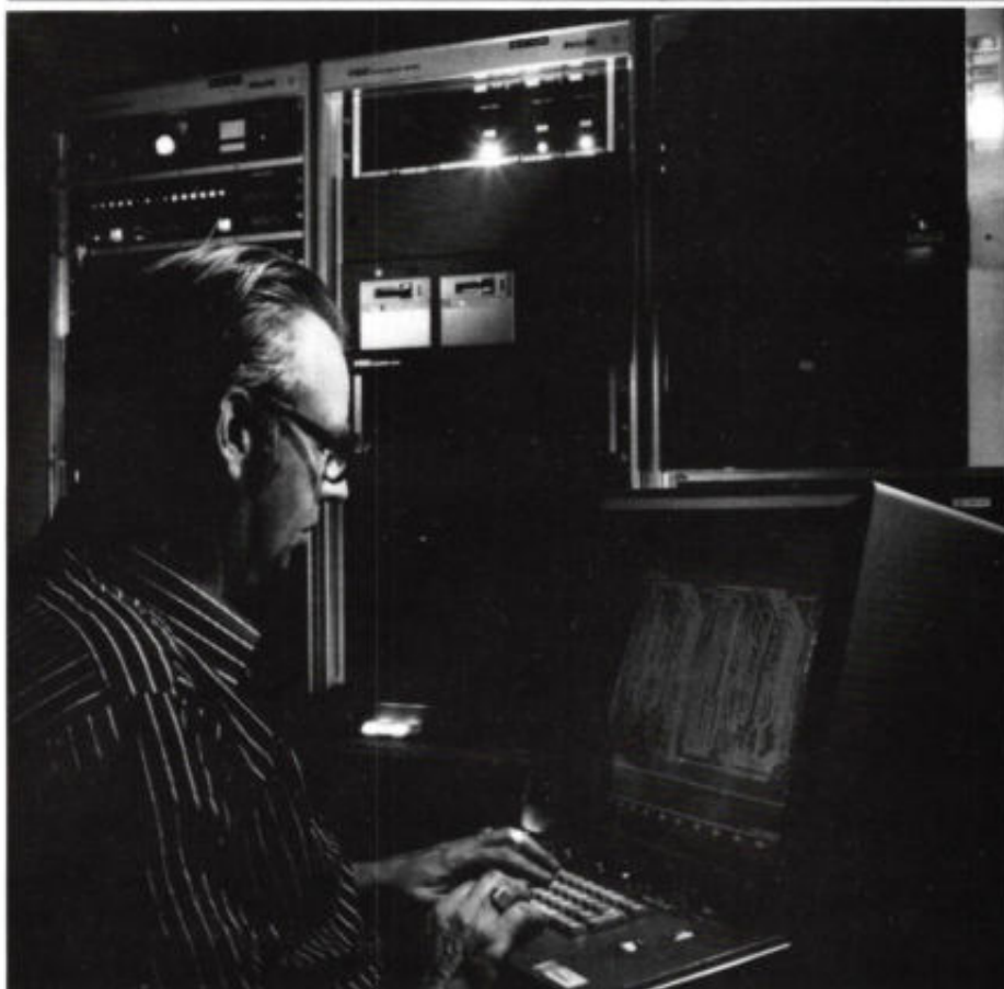
In de industrie wordt in het ontwerpproces uitgebreid gebruik gemaakt van CAD- en CAM-methoden, zoals hier bij het ontwerpen van print-layouts. Het ARCADE-project maakt een optimale gegevensoverdracht mogelijk tussen de verschillende ontwikkelingsfasen van een produkt. Deze fasen omvatten de produktspecificatie, het feitelijke ontwerpen van apparatuur en eventuele programmatuur, simulatie en analyse, layout (verwerkelijking van het ontwerp) en uiteindelijk de assemblage en de eindcontrole.
