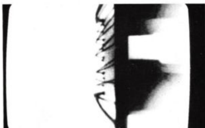
Ingekapselde geïntegreerde schakelingen verraden bij röntgendiagnose of alle hechtdraden vastzitten. Dit biedt bijvoorbeeld de mogelijkheid om ingekapselde IC's niet-destructief te inspecteren na onderwerping aan schok- of trilproeven.
