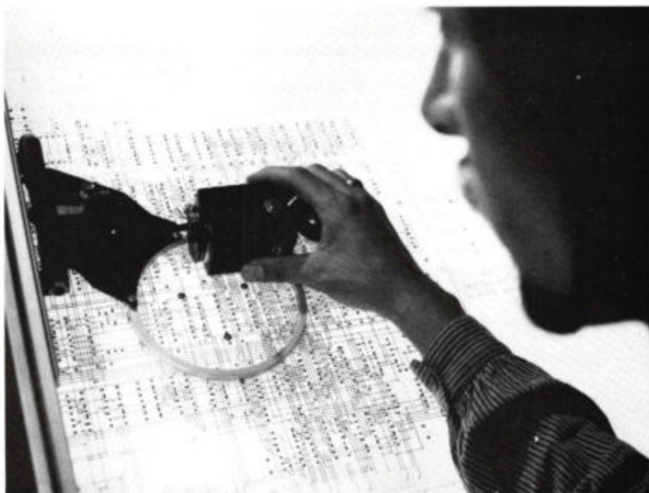
Met behulp van een specifiek programma kan op basis van de in de computer opgeslagen geometrische informatie een besturingsprogramma worden ontwikkeld waardoor een fotoplottter een foto kan produceren die bruikbaar is in het gehele productieproces. Het omzetten van geometrische informatie in besturingscoördinaten kan gebeuren door het „digitaliseren” van een print-layout.
